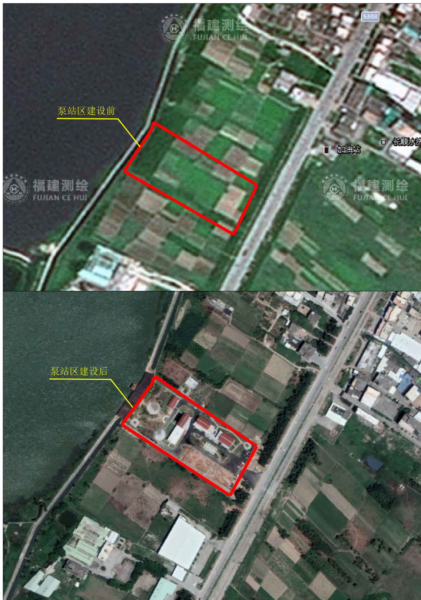
附图04泵站区建设前、后遥感影像图
